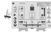
Panel de control con validación de maniobra
