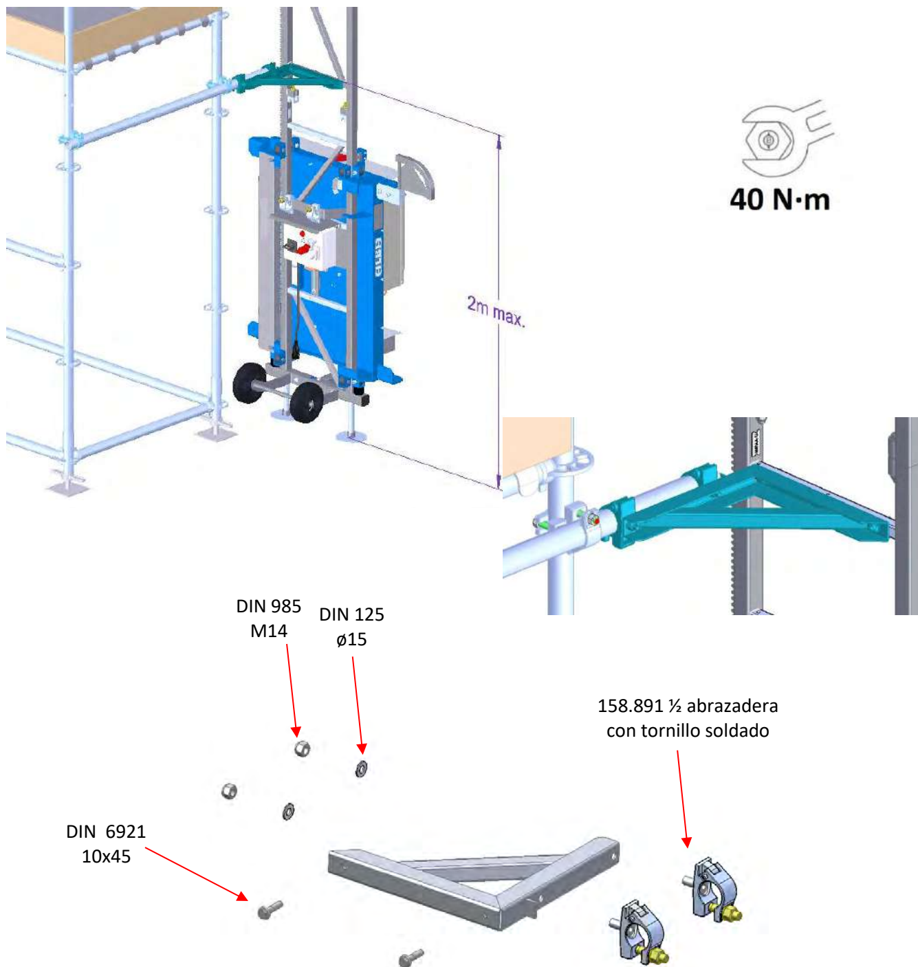
PRIMER ANCLAJE TIPO L
