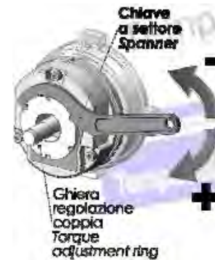
AJUSTE DEL ENTREHIERRO Y EL PAR (MOTOR MONOFASICO)
