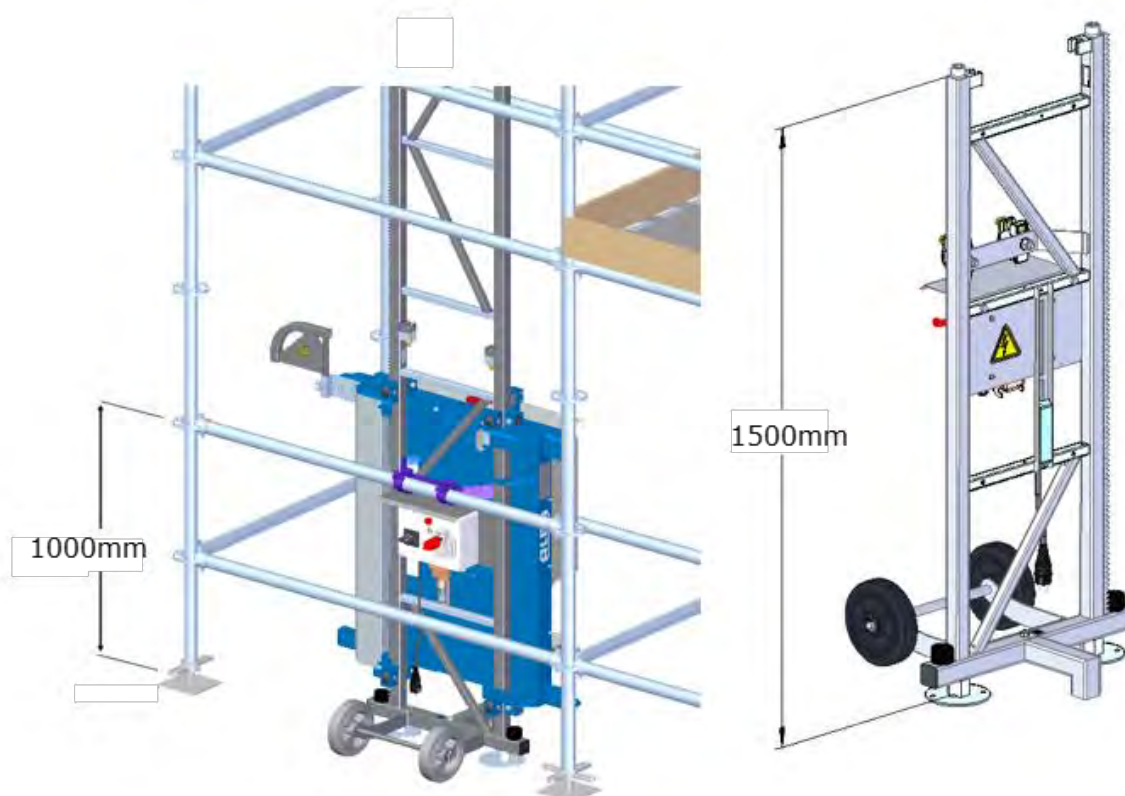
PREMIÈRE ANCRAGE SUR LA STRUCTURE
