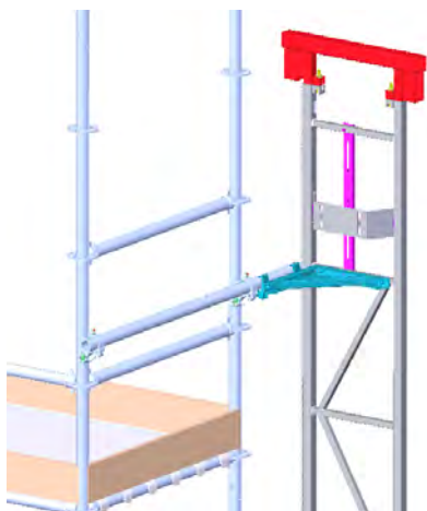
POSITION CORRECTE/INCORRECTE DE LA CAME D'ARRET SUPERIEUR - TYPE L
