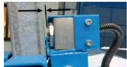
VÉRIFICATION DETECTEUR DU MÂT
