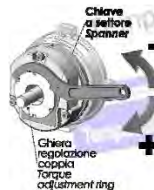
RÉGLAGE DE L'ENTREFER ET DU COUPLE DE SERRAGE (MOTEUR MONOPHASÉ)
