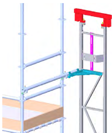
POSIZIONE CORRETTA/ERRATA DELLA CAMMA DI ARRESTO SUPERIORE – TIPO L
