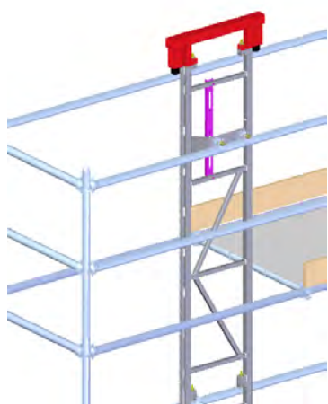
POSIZIONE CORRETTA/ERRATA DELLA CAMMA DI ARRESTO SUPERIORE - STANDARD
