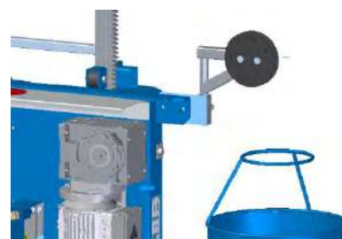
Montaggio tamburo lato destro
