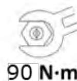
Serraggio del dado con la chiave a cricchetto per ponteggio
